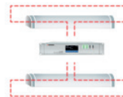
Lus, alleen kabelredundantie
